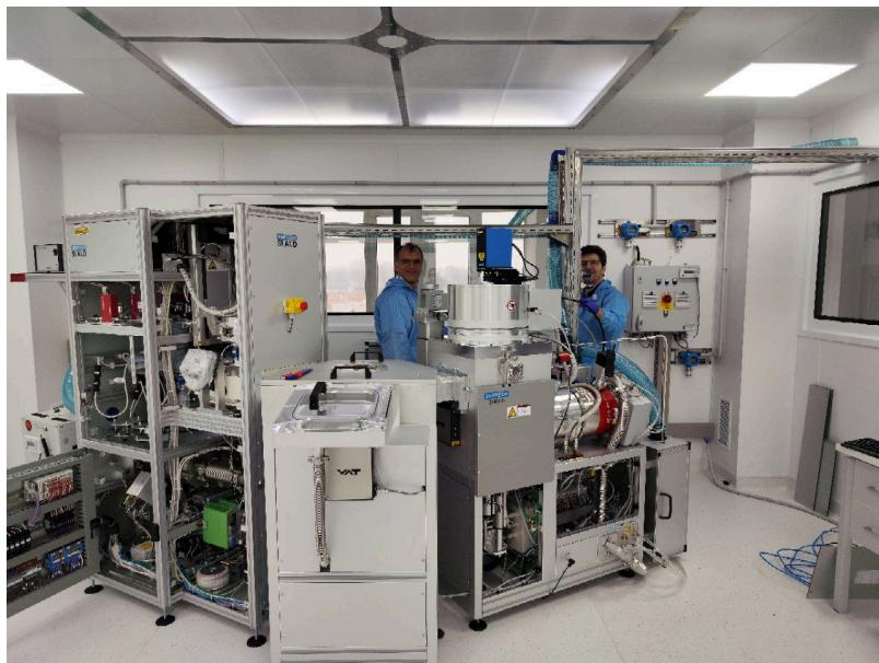
Ushbu qurilmalar zamonaviy nanostrukturalar va yarimo'tkazgich elementlarini yaratishda muhim bo'lgan nozik plyonkali qoplamlarni aniq yotqizish va ularni qayta ishlash imkonini beruvchi yagona klaster tizimiga integratsiya qilingan. Klaster ikkita asosiy texnologik jarayonni o'z ichiga oladi: plazma bilan kuchaytirilgan atomik qatlamlari cho'ktirish (PEALD) va induktiv bog'langan plazmali gaz fazasida kimyoviy cho'ktirish (ICPECVD).
