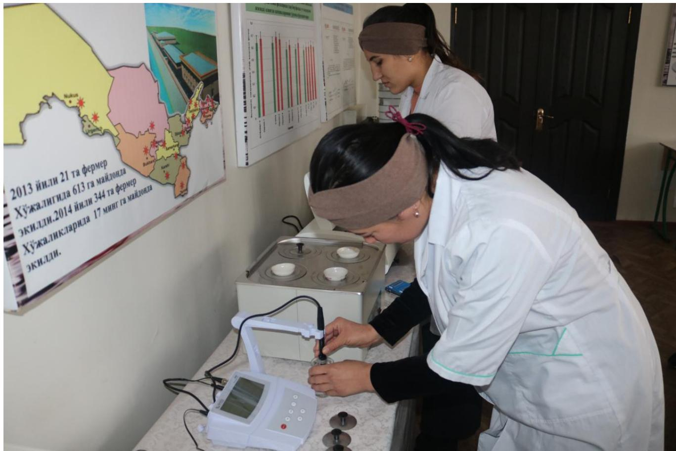
Ushbu laboratoriya suv va tuproq tarkibini kimyoviy va mexanik jihadan tahlil qilish uchun mo'ljallangan. Bu o'z navbatida qishloq xo'jaligi ekinlarini yetishtirishga mo'ljallangan yerlar tuproqlarida kimyoviy tahlillar o'tkazish orqali sho'rланish darajasini aniqlash, mexanik tarkibi, tuproq nam sig'imi kabi ko'rsatkichlarini hisobga olib, meliorativ va agrotexnik tadbirlarni to'g'ri belgilash va ekinlarni to'g'ri joylashtirish imkonini beradi.
