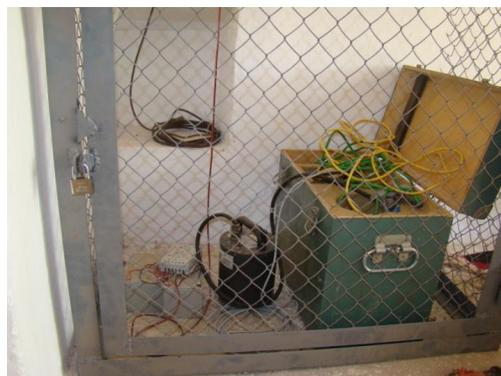
Это оборудование установлено в махаллинских сходах граждан Эгизбулак, Арнасай, Яссикечув, Эски Фориш, Мажрум, Кызылкум и Учкулоч в Джизакской области, где ведутся наблюдения с помощью современных сейсмометров (CMG-6TD, CMG-5TDE). Все установленные сейсмометры работают непрерывно от аккумуляторных батарей, которые питаются от солнечных панелей.
